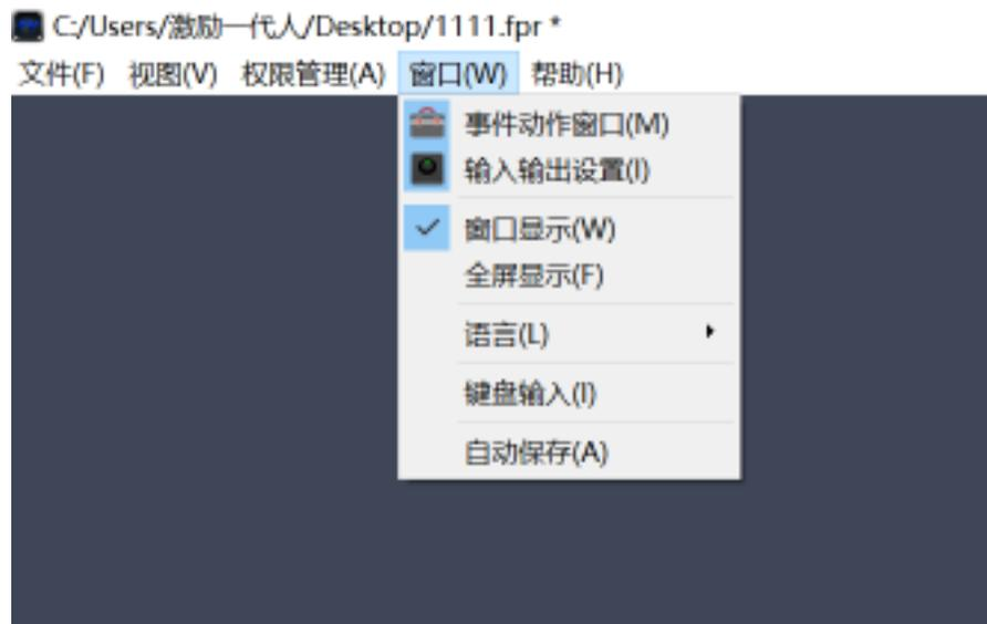
点击输入输出设置打开下图，如下图所示：对流程 1 的输入输出进行设置。1.停止就是对流程 1 停止触发，2.定时单次就是在一定的时间条件里对流程 1 触发一次，3.定时连续就是在一定的时间条件里对流程一连续触发。
