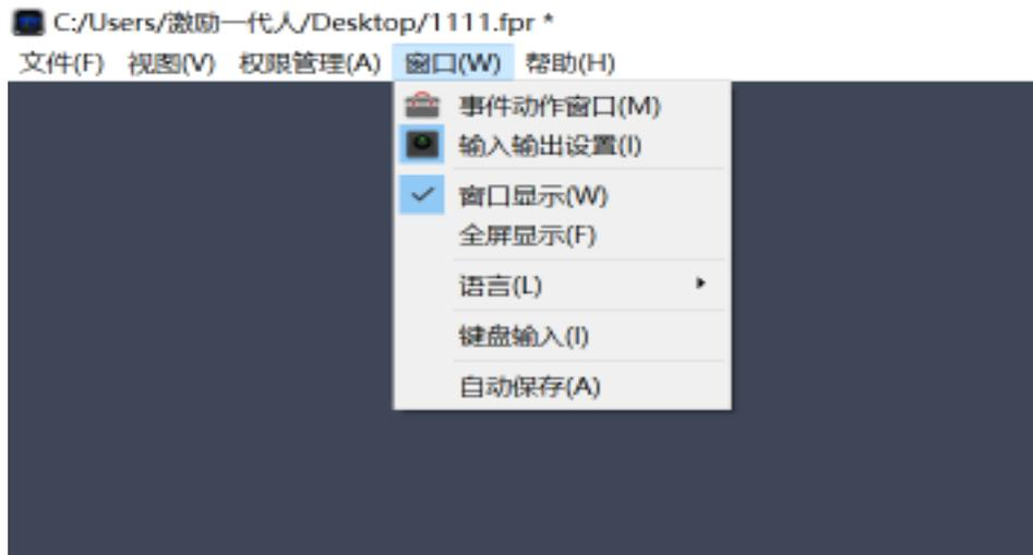
点击事件动作窗口打开下图，如下图所示：添加事件就是添加按钮按下，添加动作就是事件按钮按下后所产生的动作，例如：事件按钮按下就会打开图像采集的设置窗口。
