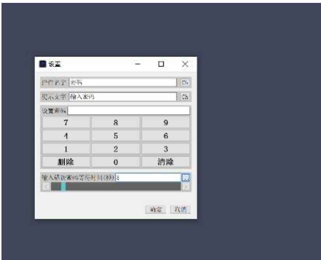
密码输入需要结合其它控件完成，例如：点击按钮打开流程里的图像采集参数设置，如果需要添加密码打开。如下图所示：先新建一个窗口，在窗口里面添加密码输入控件，接着在事件动作窗口添加事件按钮被按下显示输入密
